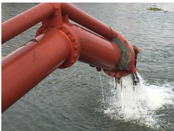
Figura 53: Pormenor do sedimento e da flora que entopem a cabeça da draga
