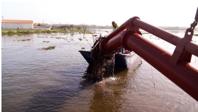
Figura 178: Limpeza da lança da Draga Grou
