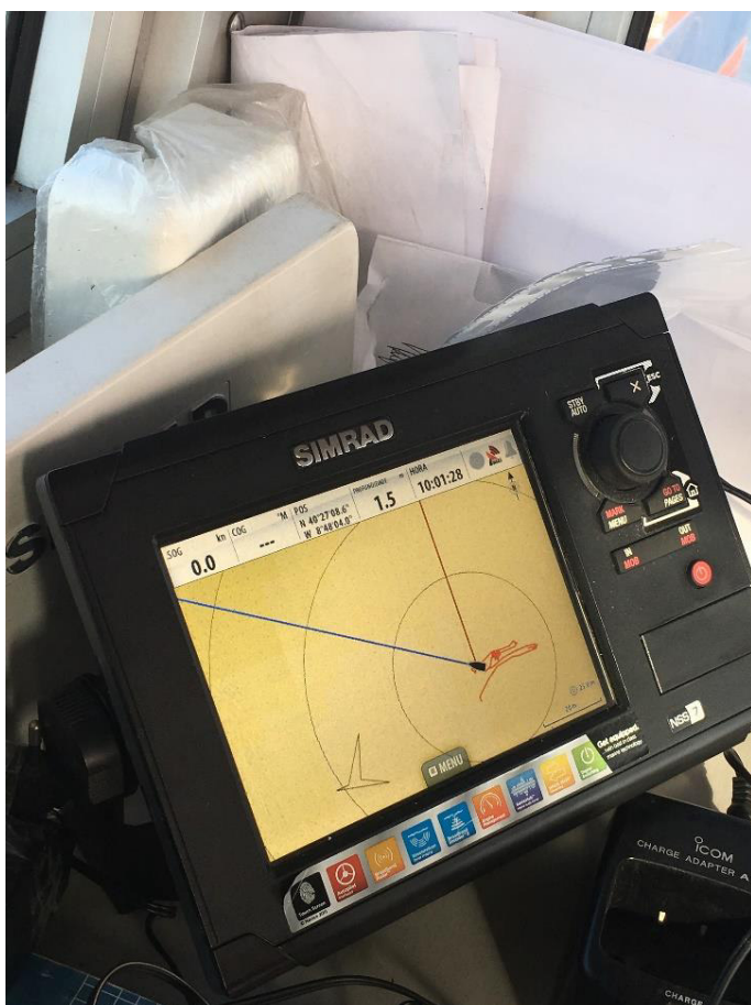
Figura 51: Computador de bordo da Grou com posição inicial da dragagem
