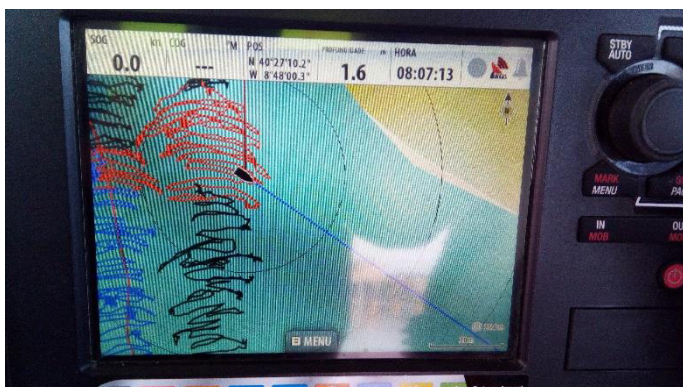
Figura 179: Computador de bordo com informações relativas à dragagem
